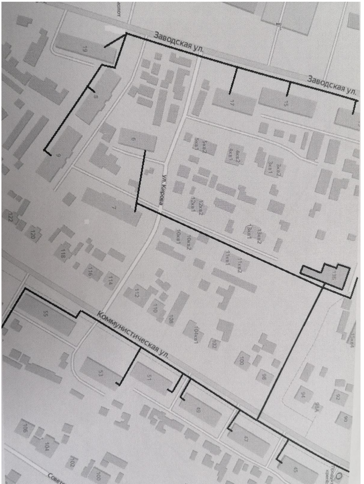
Рис. № 29 - Схема тепловой сети на участке от ул. Заводской до ул. Коммунистической
